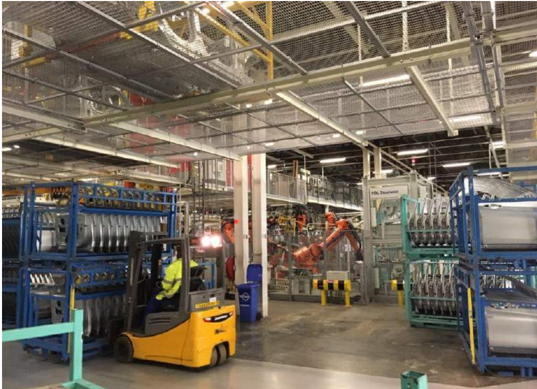
Figuur 2.6: Beeld van het transport van de pershal naar de carrosseriebouw. In de rekken kale persdelen, die gevoelig zijn voor verontreiniging, beschadiging en corrosie Carrosseriebouw
