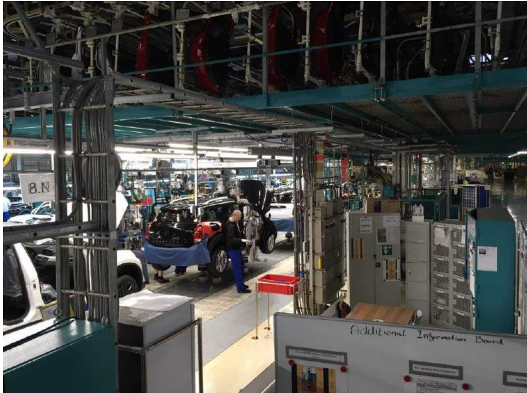
Figuur 2.9: FAS, bovenin is zichtbaar hoe onderdelen (autodeuren in dit geval) op een ander niveau worden getransporteerd
