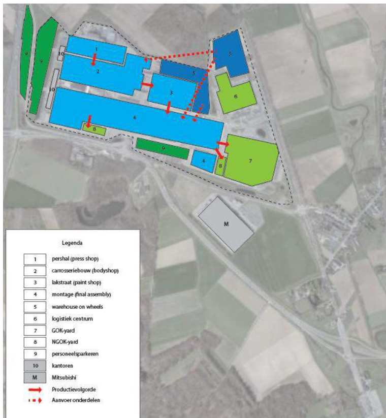
Figuur 8.84: De onderdelen van de huidige fabriek. Het productieproces begint in de pershal en eindigt in de Final assembly (FAS).
