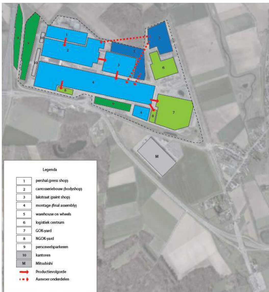
Figuur 2.3: De onderdelen van de huidige fabriek. Het productieproces begint in de pershal en eindigt in de Final assembly (FAS).
